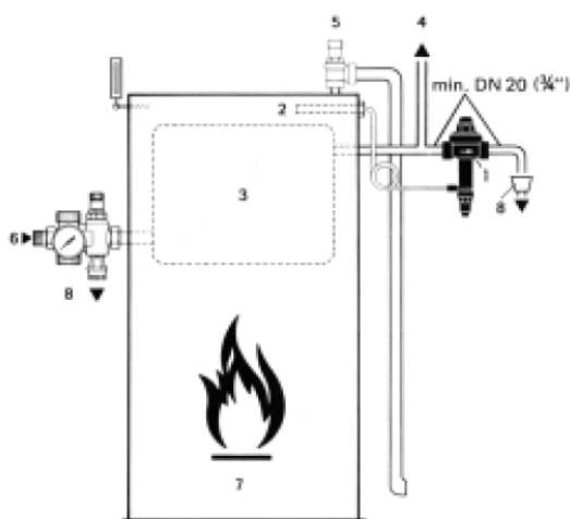
A TS130-3/4 termikus elfolyószelepek PED 97/23/EG és DIN3440 (TH 94802) tanúsítvánnyal rendelkeznek. A készülék vegyestüzelésű kazánokhoz és/vagy melegvíz tartályokhoz alkalmazható biztonsági szelep, melynek működtetését két független érzékelőelem végzi.
